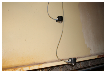
Links: Met trillingsmeters kan elke beweging, bijvoorbeeld als gevolg van een aardstok, zeer nauwkeurig worden gemeten.
